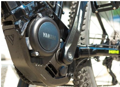
Der Motor von Yamaha liefert bis zu 80 Nm Drehmoment
