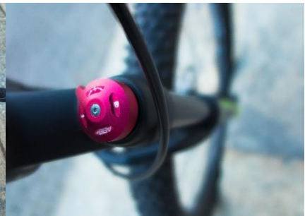
Der Lockout der Manitou Machete Federgabel mit 120 mm Federweg.
